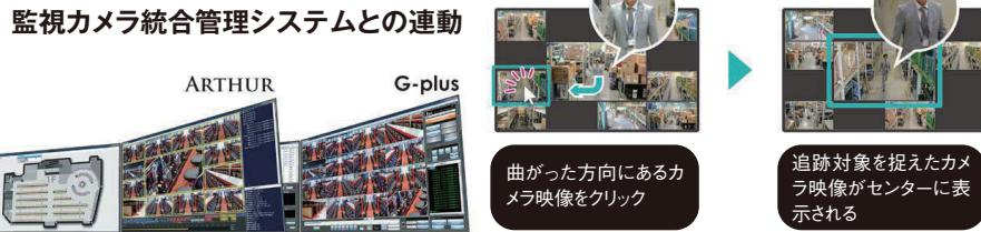
「顔」で検索した結果から、監視カメラシステムの録画映像を呼び出し、統合管理システムのリレー機能を使って、人物を追跡する。対象が移動しても周辺カメラが次々とフォロー。店内動線のトレースを徹底的にサポートする。
