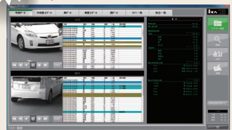
ゲート1カ所につき、入退場用で各1台ずつのカメラを設置。サーバを増設することで、最大5ヶ所(カメラ10台)まで対応。
