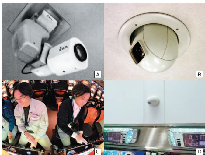
A/ドーム型以前の旋回ズームカメラ B/世界初の旋回ズーム一体型ドームカメラ。ドーム型は今や監視カメラの代名詞的形狀とえる C/遊技者の容姿・手もとをしっかりと捉える個別監視台間カメラの実際映像(映像内の人物はITVA社のスタッフ) D/台間カメラ設置例
